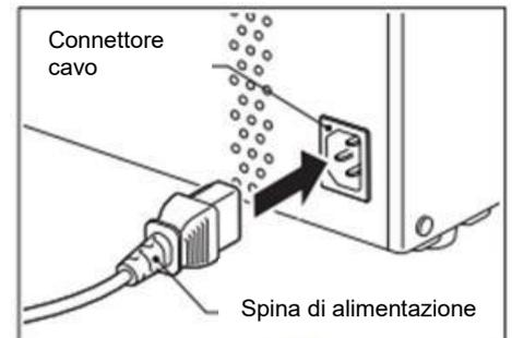
2. Connettere l'altra estremità del cavo di alimentazione a una presa dotata di adeguata messa a terra, come mostrato nella figura sottostante.
