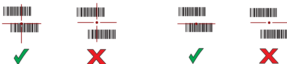
Figura 6 Modalità lista di prelievo con più codici a barre nel modello di puntamento: portata standard ed estesa
