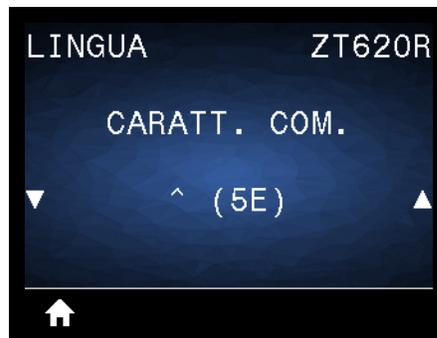
Il prefisso comando di formato è un valore esadecimale di due cifre utilizzato come indicatore di posizione del parametro nelle istruzioni di formato ZPL/ZPL II. La stampante cerca questo carattere esadecimale che indica l'inizio di un'istruzione di formato ZPL/ZPL II.
