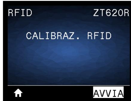
Avvia la calibrazione dei tag per supporti RFID. (Diversa dalla calibrazione dei supporti e del nastro). Durante questo processo, la stampante sposta i supporti, calibra la posizione dei tag RFID e determina le impostazioni ottimali per i supporti RFID utilizzati. Queste impostazioni includono la posizione di programmazione, l'elemento antenna da utilizzare e il livello di potenza in lettura/scrittura da utilizzare. Per ulteriori informazioni, consultare il manuale *RFID Programming Guide 3*.
