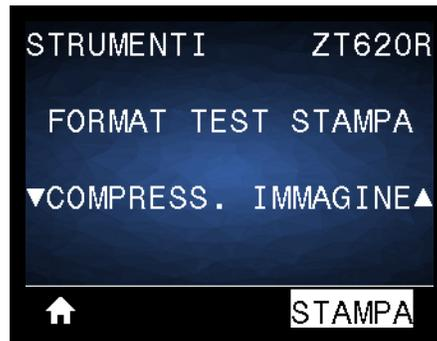
La stampante stampa un'immagine con linee diagonali, cerchi e simboli di cancelletto a intervalli regolari attorno ai bordi dell'immagine per aiutare a risolvere problemi relativi alla compressione o all'estensione di un'immagine. Per verificare se le figure vengono distorte o meno, è possibile misurare la distanza tra i simboli di cancelletto o confrontare i cerchi e le linee.
