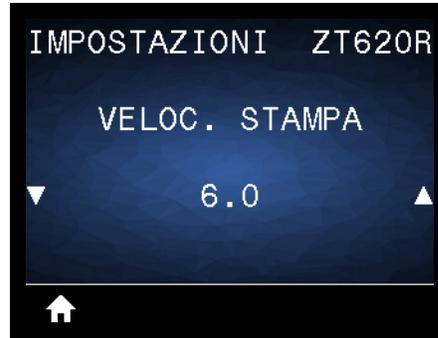
Consente di selezionare la velocità di stampa di un'etichetta, in pollici al secondo (ips). Una bassa velocità di stampa in genere permette di ottenere una migliore qualità di stampa.
