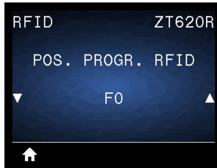
Se la posizione di programmazione desiderata (posizione di lettura/scrittura) non viene ottenuta tramite la calibrazione del tag RFID, è possibile specificare un valore.
