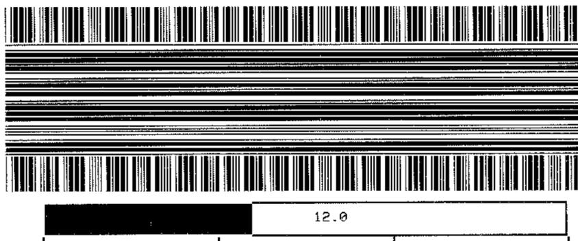
Utilizzare i numeri sulle immagini per determinare l'intensità di stampa ottimale. Se necessario, modificare il valore dell'intensità impostando quello che ha fornito i risultati migliori sulle etichette precedenti. (Vedere *INTENSITÀ* a pagina 104.)
