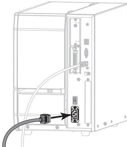
5. Inserire l'estremità maschio del cavo di alimentazione in una presa elettrica idonea.
