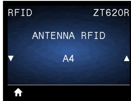
Se l'antenna desiderata non viene ottenuta tramite la calibrazione del tag RFID, è possibile specificare un valore.
