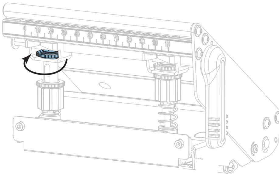
3. Riposizionare il pressore in base alle esigenze per fornire una pressione regolare sul supporto. Per supporti molto stretti, posizionare il pressore interno sul centro del supporto e ridurre la pressione sul pressore esterno.
