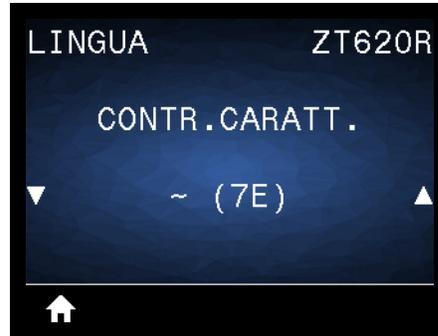
La stampante cerca questo carattere esadecimale di due cifre che indica l'inizio di un'istruzione di controllo ZPL/ZPL II. Impostare il carattere prefisso di controllo in modo che corrisponda a quello utilizzato nei formati delle etichette.
