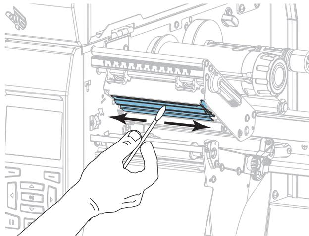
5. Ruotare a mano il rullo e, contemporaneamente, pulirlo accuratamente con il bastoncino. Attendere che il solvente evapori.
