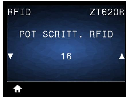
Se la potenza di scrittura desiderata non viene ottenuta tramite la calibrazione del tag RFID, è possibile specificare un valore.
