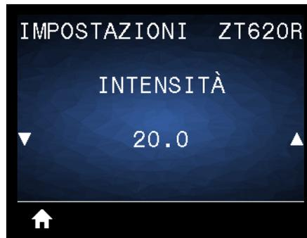
Impostare l'intensità di stampa sul livello più basso che fornisce una buona qualità di stampa. Se si imposta un valore troppo alto per l'intensità, è possibile che l'immagine dell'etichetta non venga stampata in modo chiaro, che i codici a barre non vengano analizzati correttamente, che il nastro si consumi eccessivamente o che la testina di stampa si logori precocemente.
