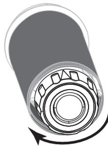
La barra di rilascio del nastro ruota verso il basso, agevolando la presa del nastro usato sul perno.
