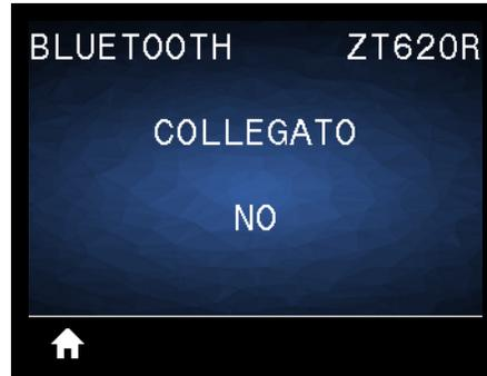
Consente di visualizzare lo stato della connessione Bluetooth con il dispositivo associato (Sì o No).
