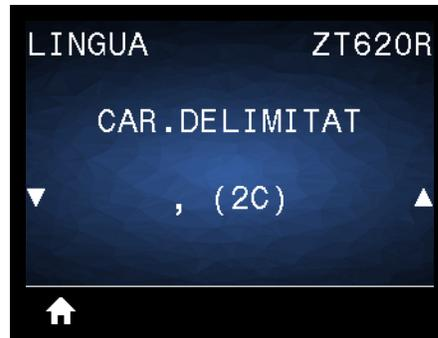
Il carattere delimitatore è un valore esadecimale di due cifre utilizzato come indicatore di posizione del parametro nelle istruzioni di formato ZPL/ZPL II. Impostare il carattere delimitatore in modo che corrisponda a quello utilizzato nei formati delle etichette.
