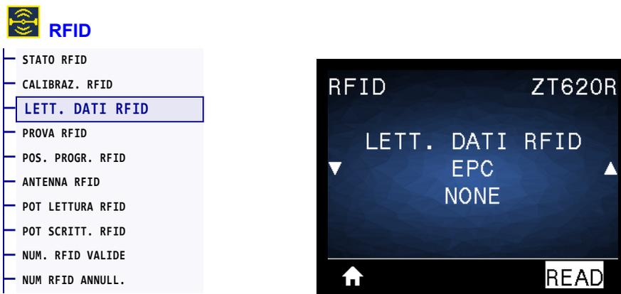
Legge e restituisce i dati del tag specificati dal tag RFID collocato sopra l'antenna RFID. Mentre i dati del tag vengono letti nella stampante non si verifica alcun movimento. La testina di stampa può essere aperta o chiusa.
