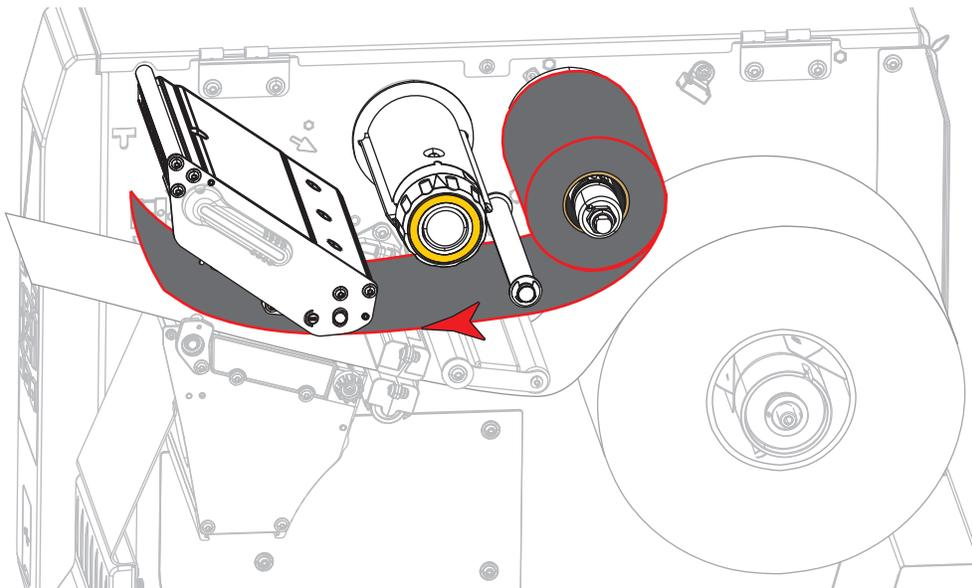
5. Con il nastro il più possibile sotto il gruppo testina di stampa, avvolgerlo attorno al perno di avvolgimento del nastro. Ruotare il perno facendo alcuni giri nella direzione illustrata per tendere e allineare il nastro.
