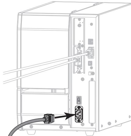
15. Inserire l'estremità maschio del cavo di alimentazione in una presa elettrica idonea.
