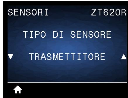
Consente di selezionare il sensore appropriato per i supporti utilizzati. Il sensore riflettente viene normalmente utilizzato solo per supporti con riga nera. Il sensore trasmissivo viene normalmente utilizzato per altri tipi di supporti.
