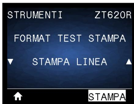
La stampante avvia una sequenza di test che stampa più volte un'immagine di prova dell'inchiostro/testina di stampa a velocità variabili. Queste etichette di prova possono essere utilizzate quando si regolano i gruppi meccanici della stampante oppure per determinare se qualche elemento della testina di stampa non funziona.
