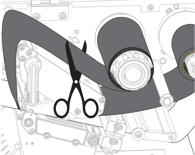
**Attenzione** • Evitare di tagliare il nastro direttamente in corrispondenza del perno di avvolgimento del nastro, che potrebbe danneggiarsi.
