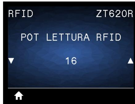
Se la potenza di lettura desiderata non viene ottenuta tramite la calibrazione del tag RFID, è possibile specificare un valore.
