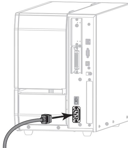
3. Inserire l'estremità maschio del cavo di alimentazione in una presa elettrica idonea.
