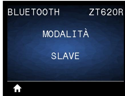
Consente di visualizzare il tipo di associazione della connessione Bluetooth del dispositivo della stampante - Slave (tipico) o Master.
