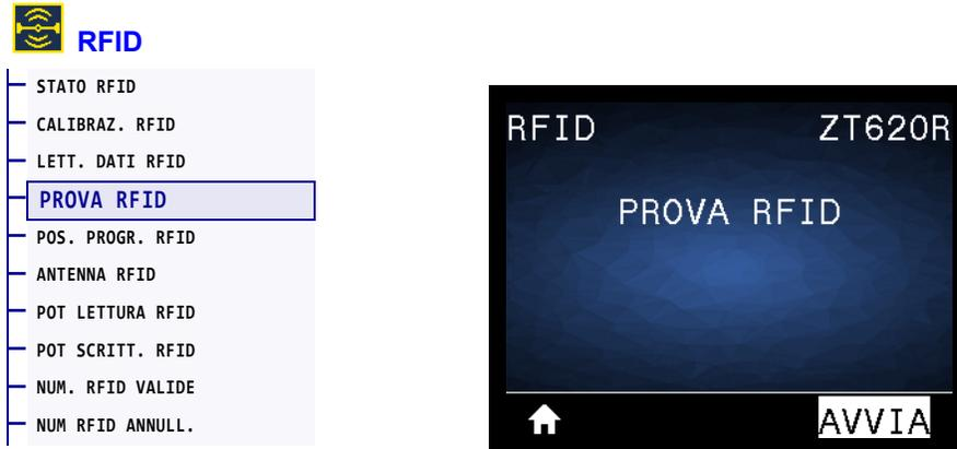
Durante il test RFID, la stampante tenta di effettuare un'operazione di lettura e scrittura su un transponder. Durante il test non si verifica alcun movimento nella stampante.
