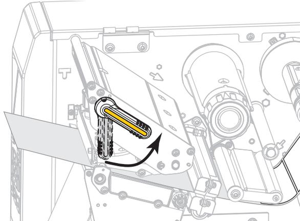
10. Spingere in avanti il supporto in modo da posizionare un'etichetta sotto il sensore supporto.
