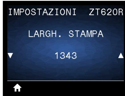
Consente di specificare la larghezza delle etichette utilizzate, espressa in punti. Il valore predefinito è la larghezza massima per la stampante, basato sul valore in DPI della testina di stampa.
